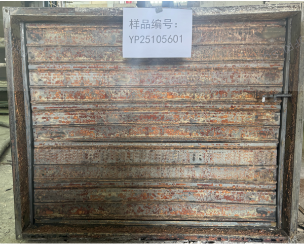
照片 2 耐火性能试验结束后试件情况
